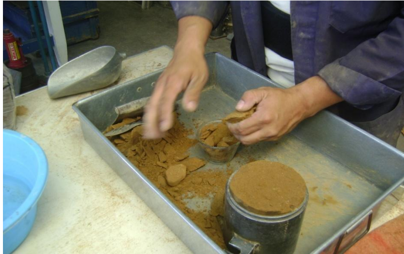
Fotografía 16 Toma de muestra para el contenido de agua
