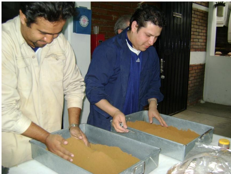
Fotografía 3 Homogenización del material a compactar
