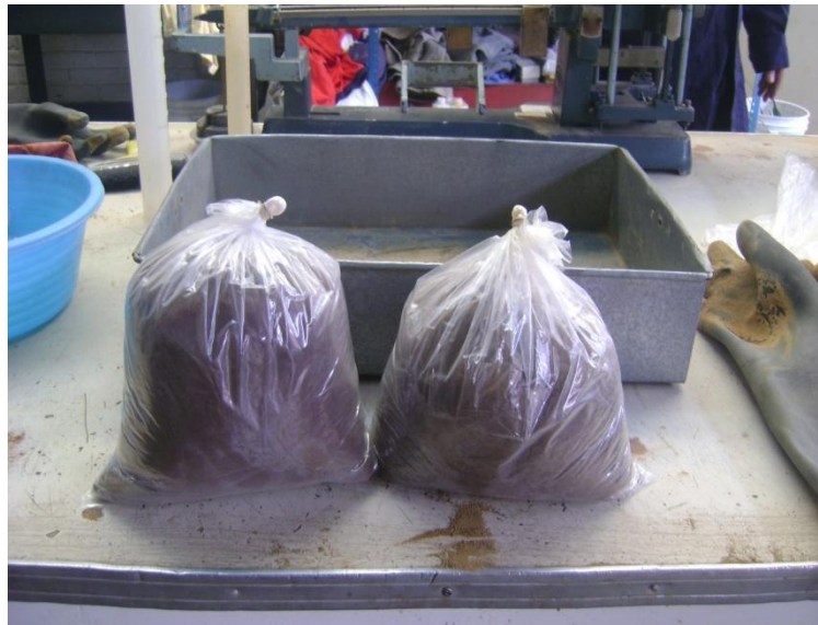
Fotografía 6 La muestra se coloca en bolsas y se deja reposar por 24 horas en el cuarto de curado
