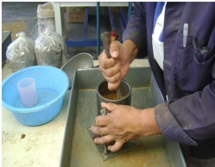
Fotografía 11 Retiro de la extensión del molde Proctor
