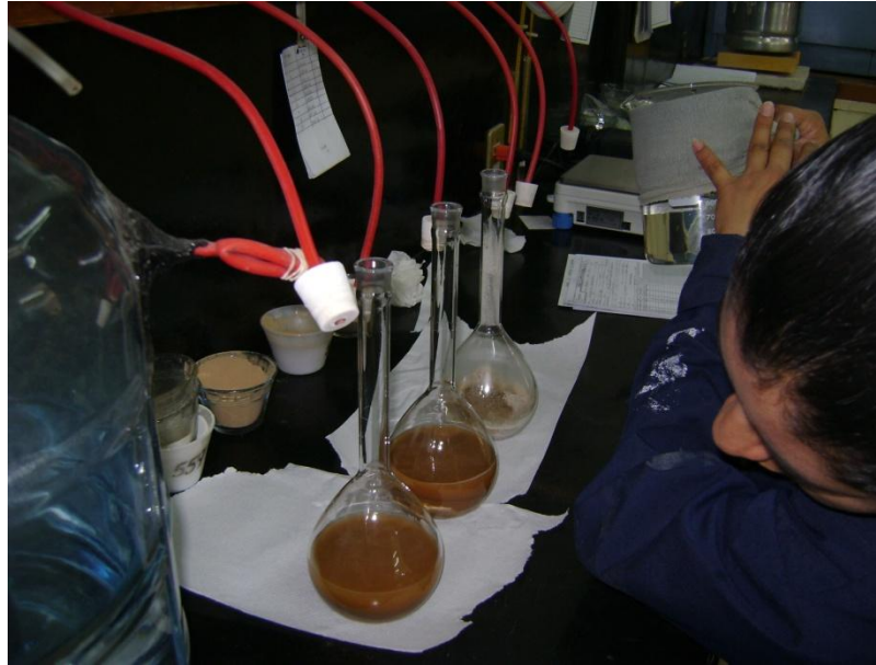
Fotografía 11 Llenado de agua hasta la mitad del matraz
