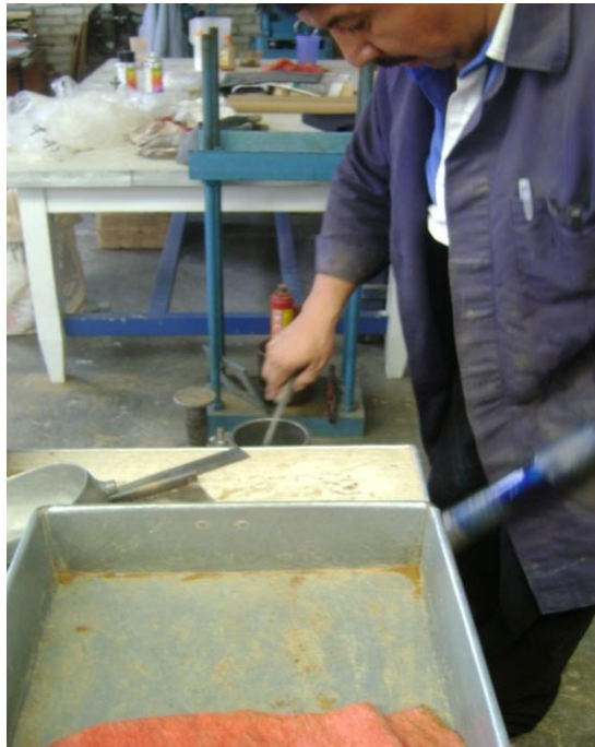
Fotografía 8 Raspado de la capa compactada
