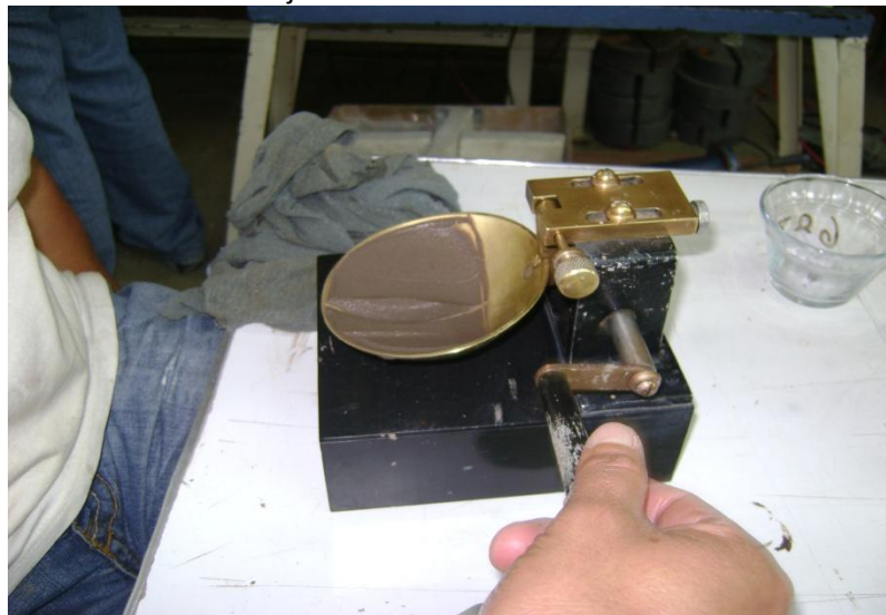
Fotografía 6 Determinación del número de golpes
