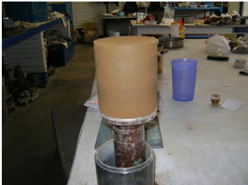
Fotografía 15 Retiro del material compactado del cilindro
