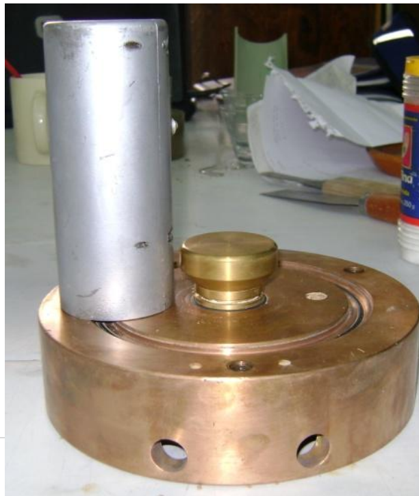
Fotografía 4 equipo utilizado: pisón, molde tipo caña, collarín de Lucita y cámara triaxial
