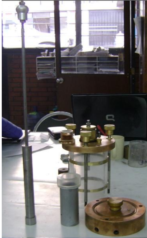
Fotografía 4 equipo utilizado: pisón, molde tipo caña, collarín de Lucita y cámara triaxial
