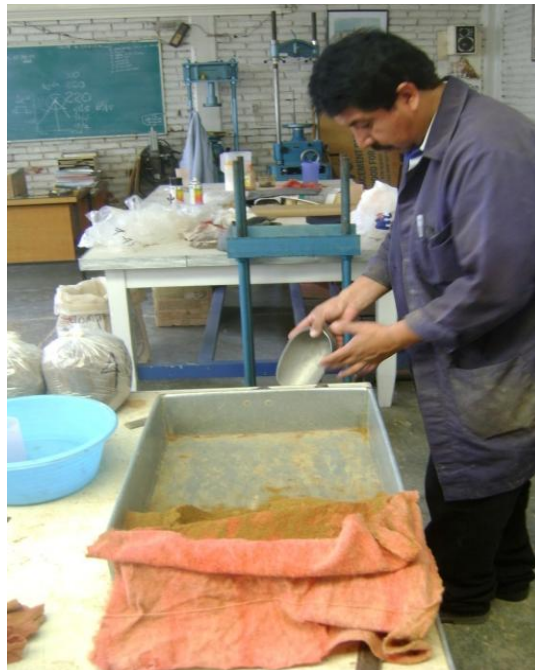
Fotografía 9 Añadiendo material a compactar
