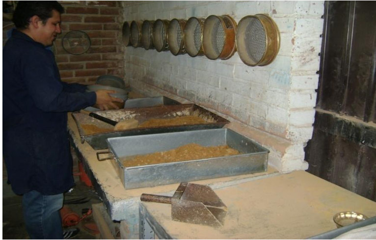
Fotografía 2 Cribado a través de la malla número 10
