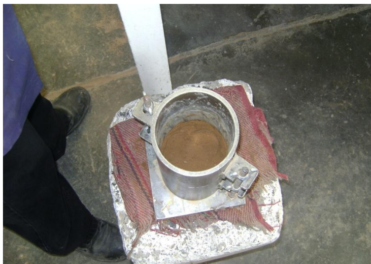
Fotografía 7 Bloque de concreto utilizado para la compactación
