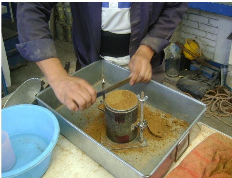
Fotografía 13 Enrasado del molde con una regla metálica
