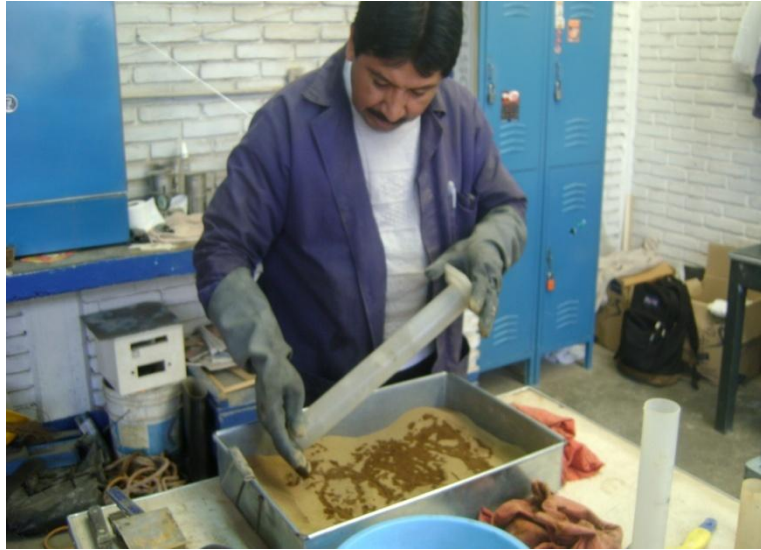
Fotografía 4 Suministro de agua requerida para preparar la muestra
