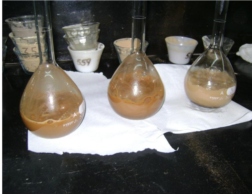
Fotografía 13 Extracción del aire contenido en los matraces
