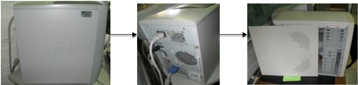
Figura 4.9 Seguimiento de la separación del gabinete.
