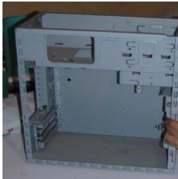
Figura 4.19 Carcasa después de la separación manual
