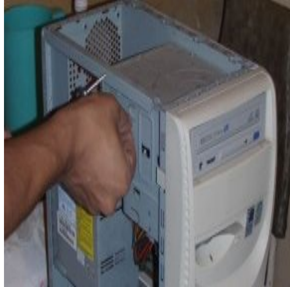
b) Destornilla del lado izquierdo del gabinete
