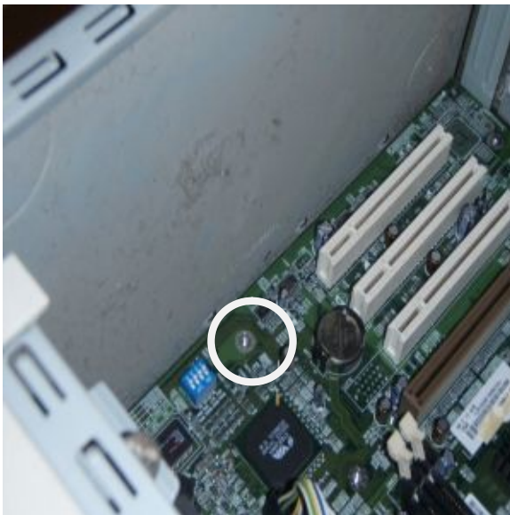
a) Tornillo que fija la tarjeta madre a la carcasa
