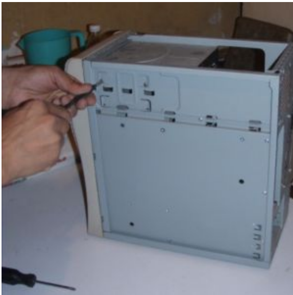
c) Destornillar del lado derecho de gabinete
