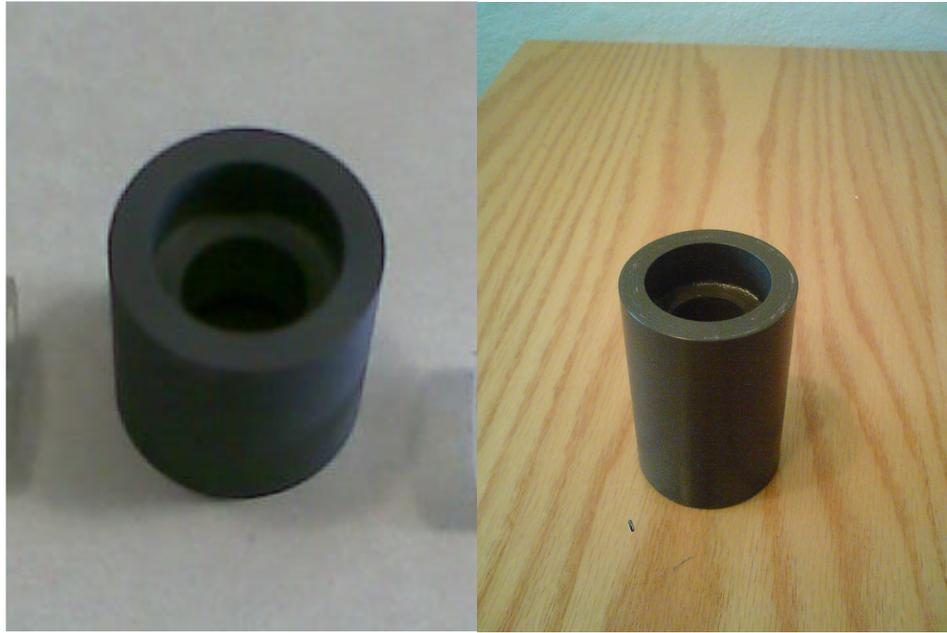
Figura 4. 1. Portamuestras para muestras de una y dos pulgadas
