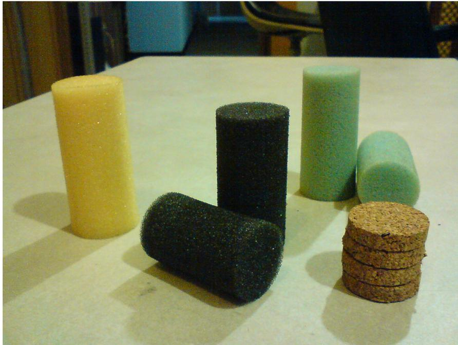
**Figura 4. 8.** Espumas de poliuretano y capas de corcho utilizadas en las pruebas
