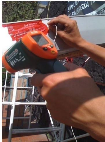
FIGURA 3.23. Toma de temperatura del colector B, por medio de termopar.
