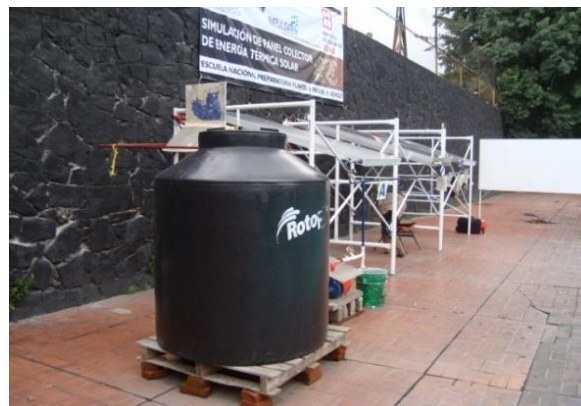
FIGURA 3.6. Tanque de almacenamiento
