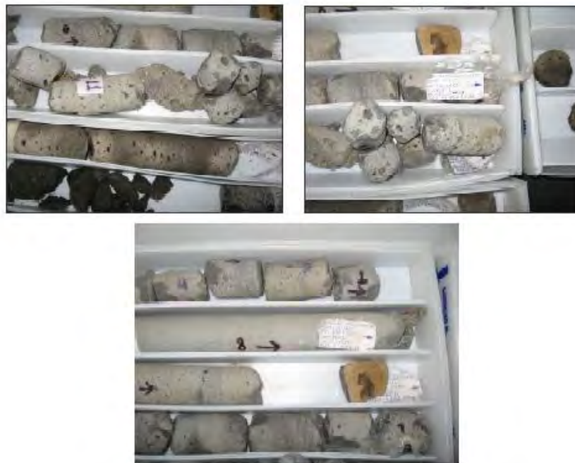
Fotografía 2 .Detalle de muestras recuperadas de roca basáltica de la perforación SM-01.
