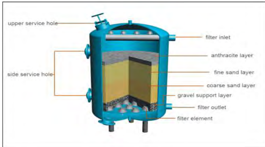
Figura 5.8 Filtro de carbón activado
