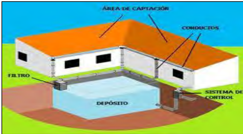
Figura 4.1. Captación de agua pluvial en techos de casas (SITIOSOLAR)
