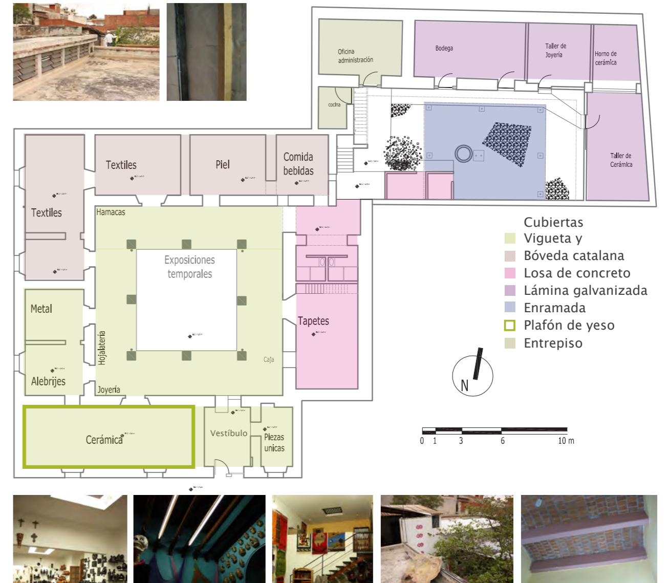
Lamina 17 Materiales de construcción de las cubiertas
