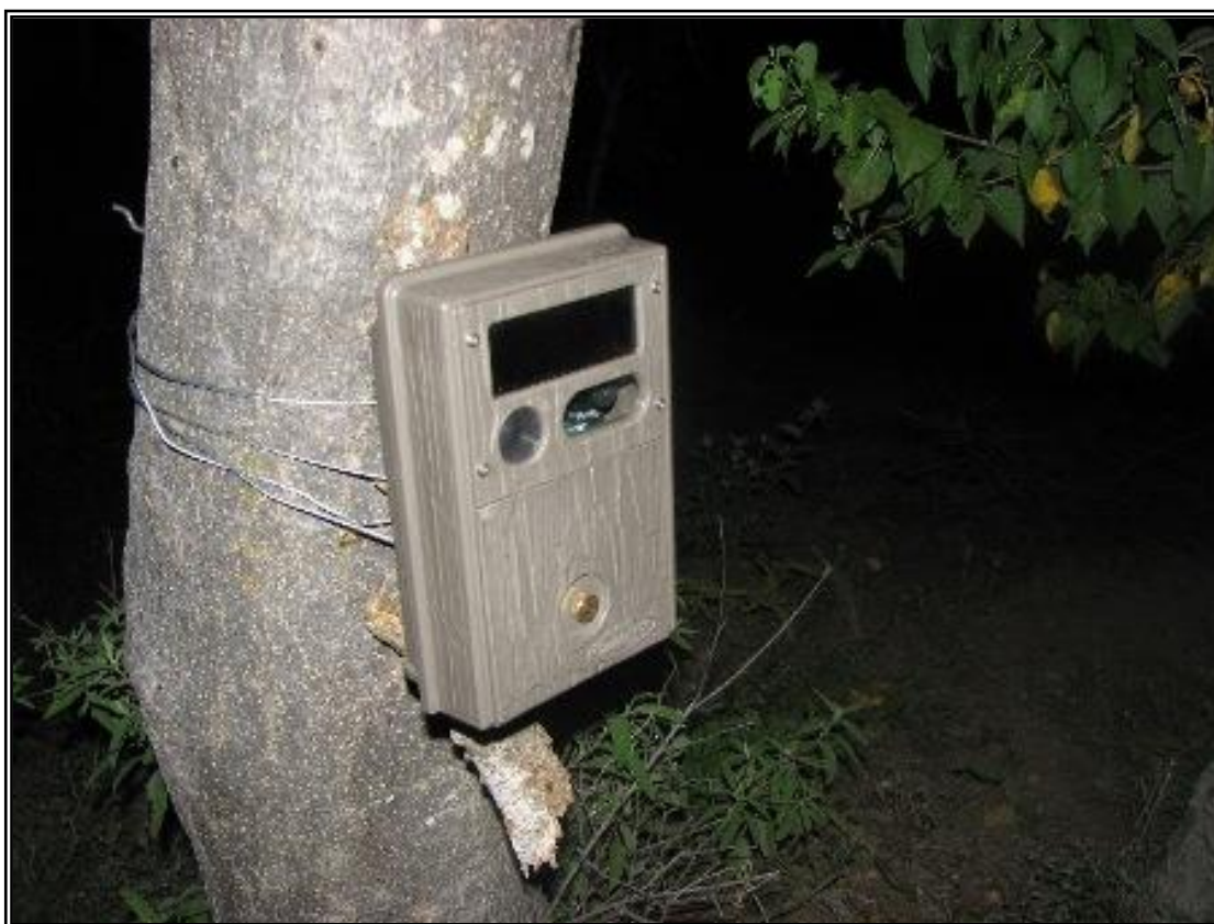
FIGURA 8. Fototrampa infrarroja digital Cuddeback utilizada en el municipio de Cosoltepec, Oaxaca (fotografía: O. Pérez Martínez).
