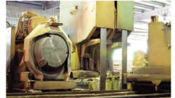
Proceso básico de desprendimiento de viruta que emplea una hoja triscada con una serie de dientes en el borde. Fuente: www.serrerialarranaga.com/public_medios/ctrl_...
