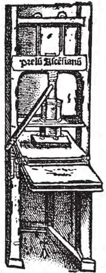
Una prensa en tiempos de Gutenberg. Fuente Parramón y Cantó. Entre el diseño y la edición. Tradición cultural e innovación tecnológica en el diseño editorial.
