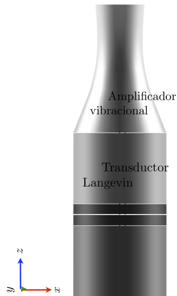
Figura 2.3: Transductor Langevin con amplificador vibracional
