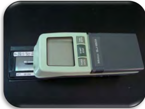
Figura 11. Rugosímetro (Mitutoyo. SJ-201. Japón)
