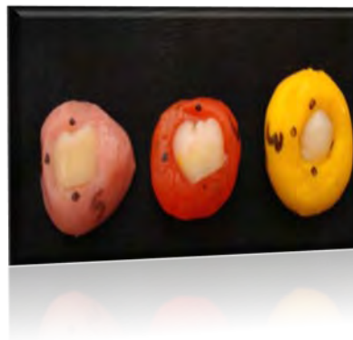
Figura 9. Se muestran dientes montados sobre acrílico paralelizados para su medición en el rugosímetro.
