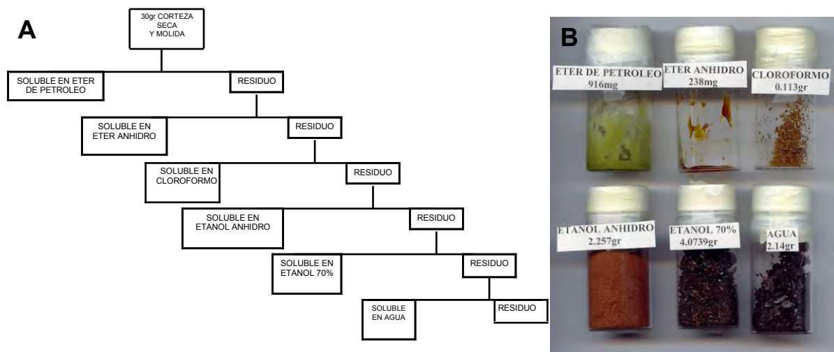
Figura 12. A: Diagrama de flujo de los pasos de la extracción continua con diferentes solventes. B: Aspecto de las fracciones y su rendimiento.
