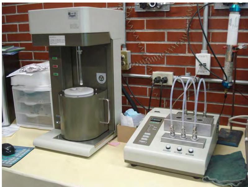
*Figura 2.6 Equipo Bel-Japan Minisorp II, usado para medir el área superficial.*
