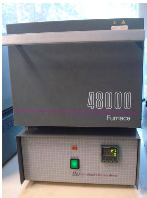
Figura 2.2 Mufla Thermolyne 4800, usada en la síntesis del  $\text{Li}_4\text{SiO}_4$ .
