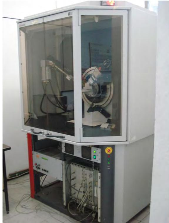
*Figura 2.5 Difractómetro Bruker AXS D8 Advance.*
