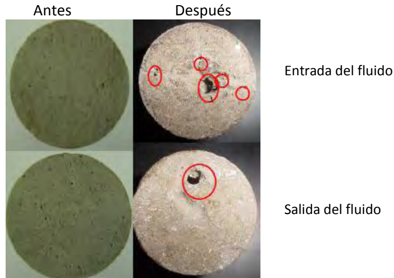
Figura 3-2. Agujeros de gusano generados en un núcleo debido a la inyección de una mezcla con 15% de HCl y un 9% de ácido fórmico. 6
