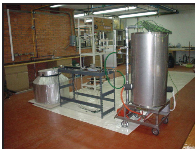
Fig. 3.8. Montaje final del sistema de recirculación de agua y de la línea de trabajo.
