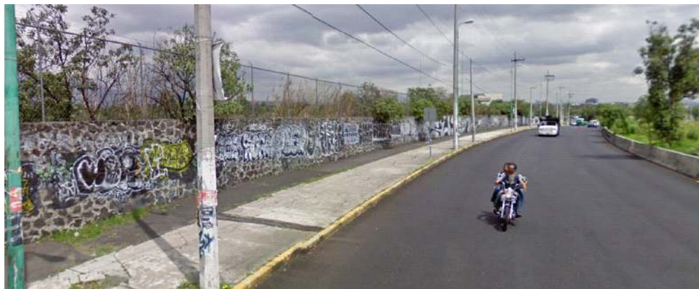
Foto 2. En esta fotografía se aprecia el límite del predio con la Av. Antonio Delfín Madrigal y se observa un ancho de banqueta de 4.00 m y un ancho de calle de 8.50 m.
