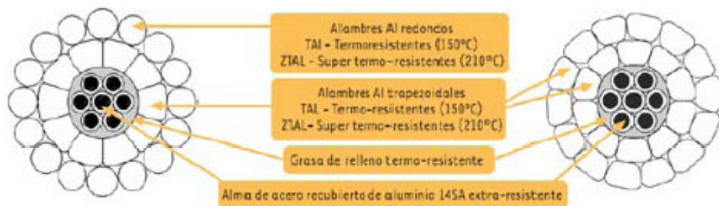
Figura 3.1. Construcción interna de algunos conductores HTLS.
