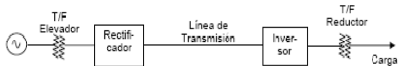
Figura 5.3. Esquema típico de un sistema de transmisión en HVDC.
