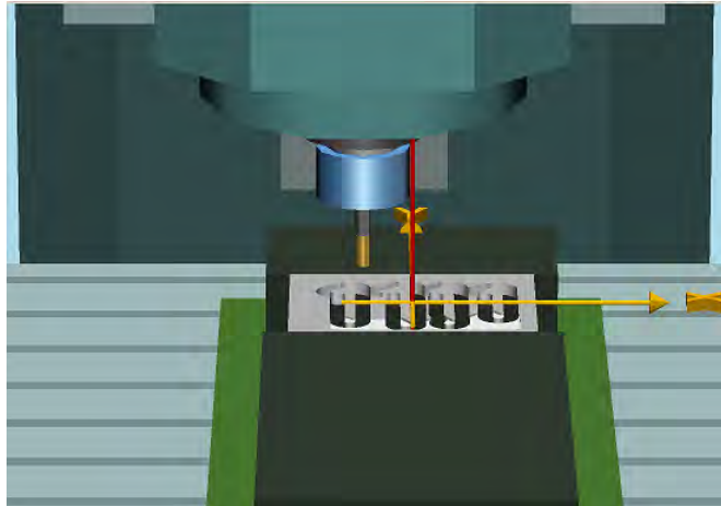
Figura 5.9: Simulación del proceso de maquinado en TopCam
