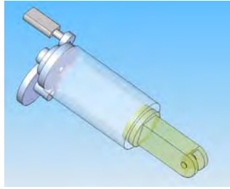
Figura 2.3: Sistema de transmisión acoplado del motor al tornillo de transmisión [5]
