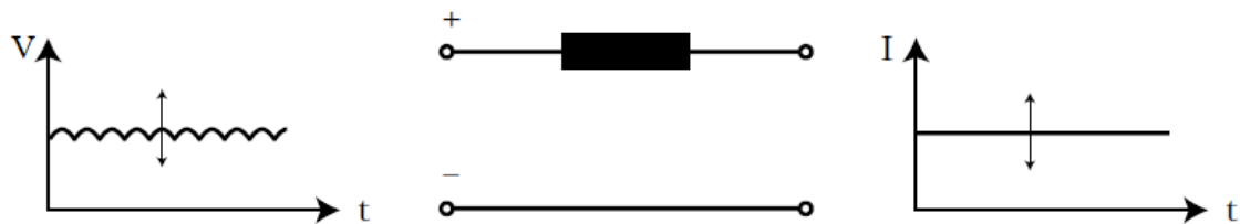
Figura A.08 Circuito intermedio de CD variable.
