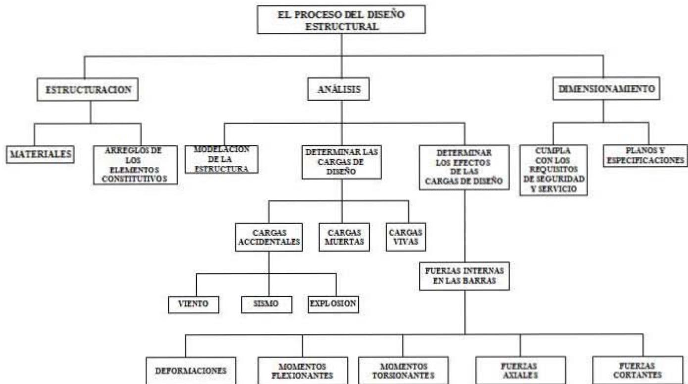
Fig. 1.2 Organigrama del Proceso del Diseño Estructural.
