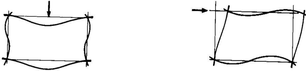
**Fig. 2.51 Deformaciones de un tablero de marco rígido.**
