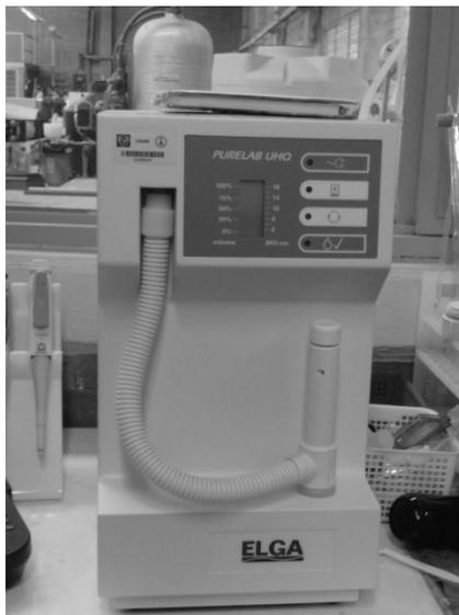
**Figura 13.** Equipo desionizador de agua potable.
