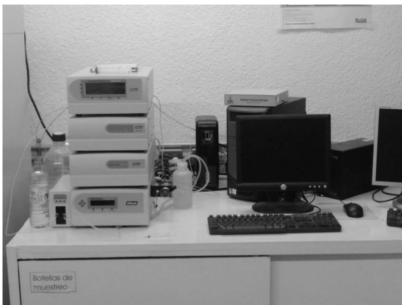
**Figura 12.** Equipo de cromatografía iónica en el laboratorio de cromatografía del Edificio 8 del Instituto de Ingeniería.
