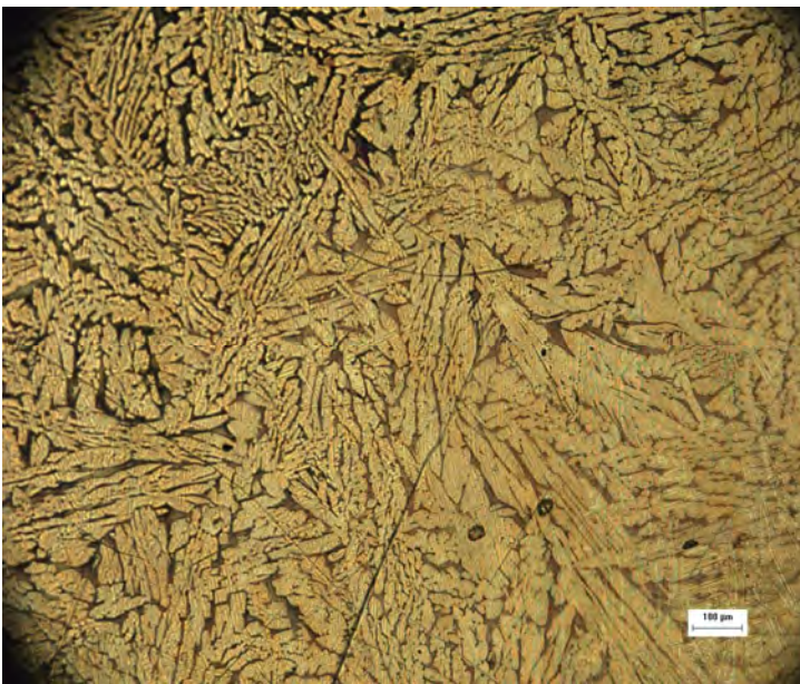
Figura 9.- Microestructura dendrítica de la muestra LAB-2.
