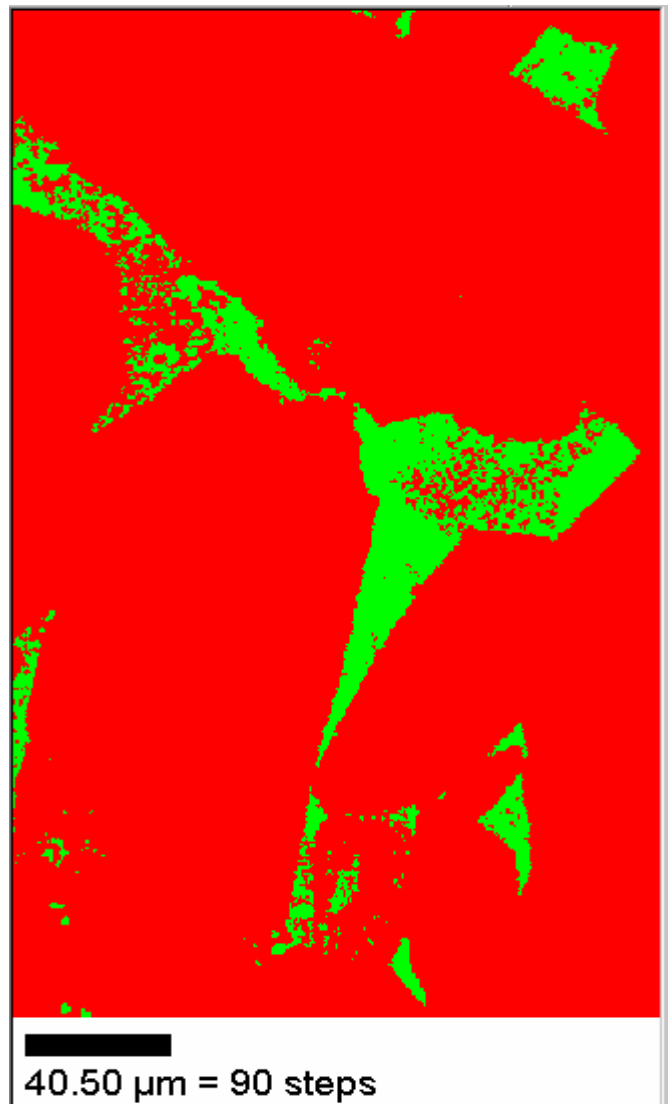
Figura 24b.- Mapa de fases de la muestra homogenizada LAB-2-H
