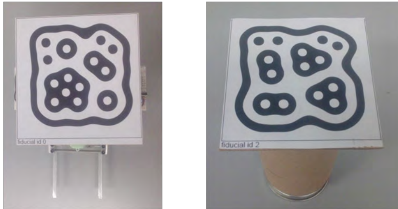
Figura 6. 2: Fiducials para los cobots y las cajas.
