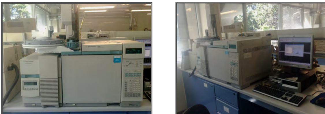
Figura 5.7. Cromatógrafo de gases y espectrómetro de masas (Instituto de Ingeniería, UNAM).
