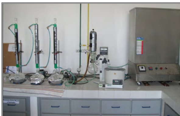
Figura 5.5. Sistema de reflujo termo-regulado para extracción de MO E , rotavapor (al centro de la imagen) y recirculador automatizado (derecha).
