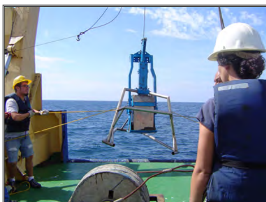
Figura 5.3. Muestreadores. a) Nucleador de caja tipo Reineck . b) Draga Smith-McIntyre .
