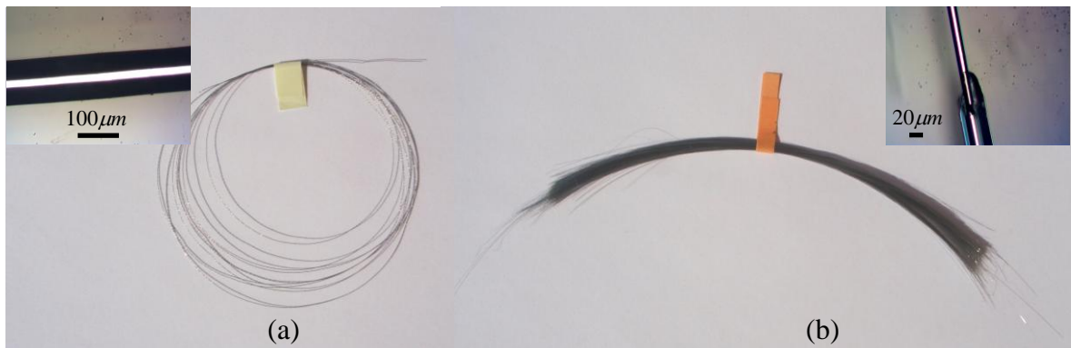
Figura 39. Aleaciones amorfas de composición \text{Fe}_{72}\text{B}_{19.2}\text{Si}_{4.8}\text{Ta}_4 : (a) Microalambre obtenido por la técnica de temple en baño de agua giratoria y (b) Microhilo recubierto con vidrio obtenido por la técnica de Taylor Ulitovsky (Fotografías obtenidas en microscopio óptico a 20x aumentos).
