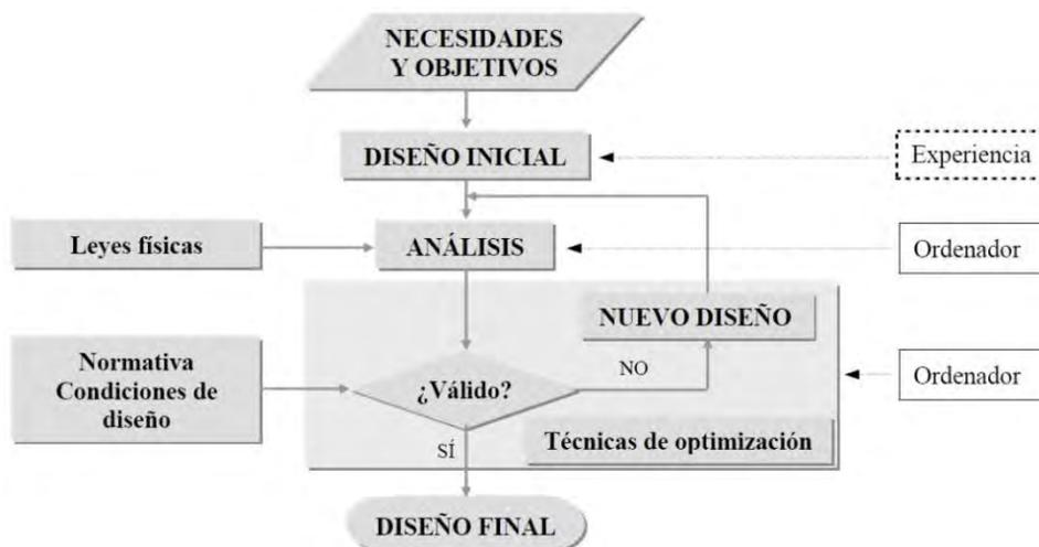
Figura 2.2 Diseño Optimizado [10].
