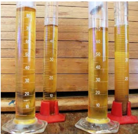
Figura e.28 Después de 14 horas se realizó el filtrado de la muestra 2 (figura e.28). Teniendo una pérdida por sedimentos del 26 % de partículas solidas.
