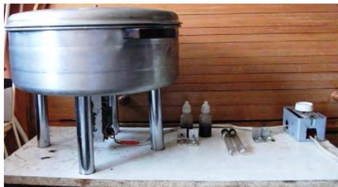
Figura e.4 Dispositivo centrífugo para pruebas preliminares
