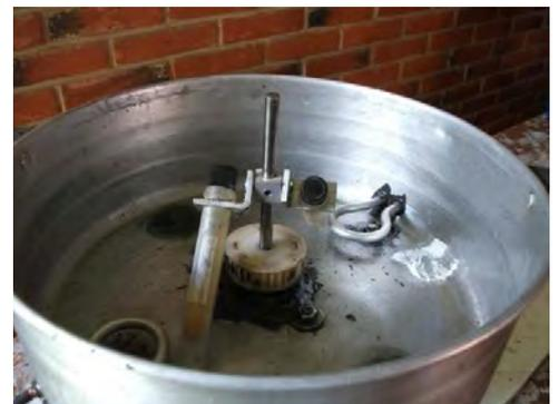
Figura e.5 Adición de resistencias electricas para calentar agua.
