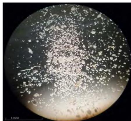
Figura e.9. Muestra de aceite tomada a 80X en un microscopio óptico, como se puede observar existen partículas suspendidas en una fase intermedia de aceite.
