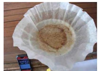
Figura e.27 En la muestra 3 a pesar de tener una semana de uso, no tiene tantas partículas retenidas debido a que los glóbulos grasos de alta densidad se depositaban en el fondo del recipiente y eran retirados con un colador cada vez que se reutilizaba.
