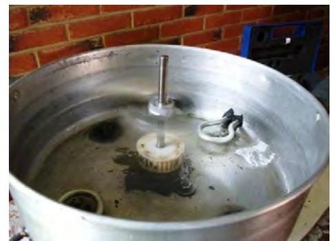
Figura r.4 Es importante tener en cuenta la temperatura a la que se va a realizar el centrifugado debido a que si se trabaja en regiones polares la densidad del aceite podría aumentar por lo que se requeriría de un precalentamiento de la mezcla.
