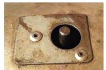
Figura d.2 parche de acero para evitar desgaste por vibración
