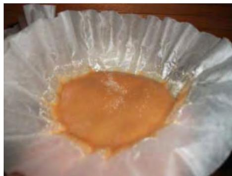
Figura e.26 Como se puede observar en la muestra 2, se tiene una mayor concentración de partículas debido a que dicha muestra se utilizó para freír papas y pollo entre otros por lo que además de partículas retenidas se aglomeran glóbulos grasos de alta densidad en el filtro .
