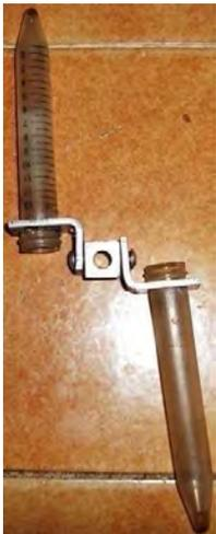
Figura a.36 Sistema de sujetador de tubo de ensayo.
