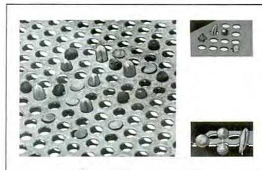
**Figura a.2** Tamizado por rejilla vibratoria. Como se puede observar los granos o partículas de mayor tamaño a la rejilla son retenidos por la maya de separación.
