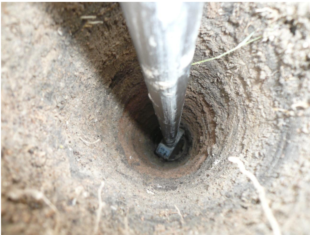
Figura 20. Obtención de muestra de residuo sub-superficial con equipo Auger.
