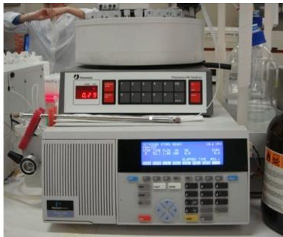
Figura 18. Sistema HPLC que consta de un separador Perkin Elmer (Serie 200), columna de intercambio catiónico (Supelcosil LC-SCX), fase móvil (piridina 2.5 mM) y un colector de fracciones (Pharmacia LKB Redfrac).
