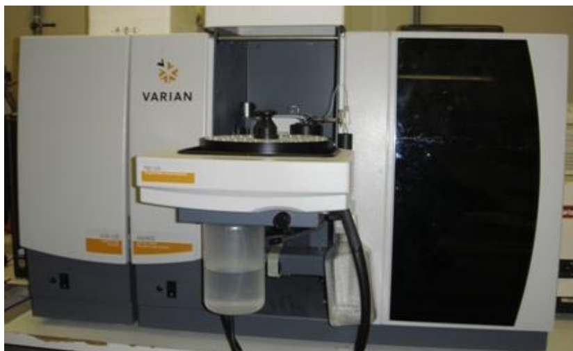
Figura 13. Espectrofotómetro de absorción atómica con efecto Zeeman acoplado con horno de grafito (Varian GTA-120).
