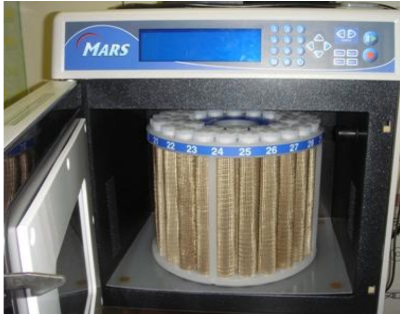
Figura 12. Horno de microondas CEM, MARS utilizado para las digestiones de tejido liofilizado.
