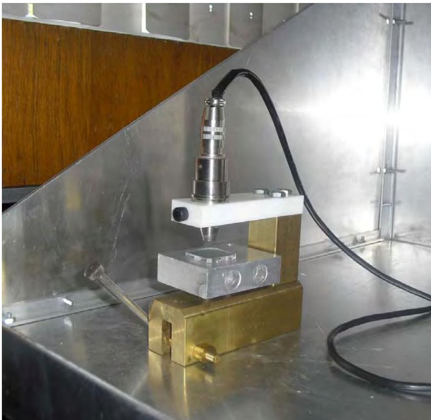
**Figura 6.9.** Dispositivo de medición en configuración de cuatro puntas.
