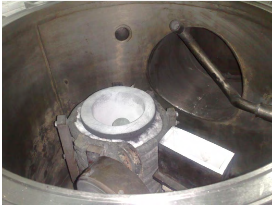
Figura 3. 1: Crisol recubierto con elementos constitutivos de la aleación en la cámara de fusión del horno.
