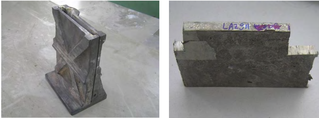
Figura 3. 2: Lingotera utilizada para el proceso de fundición y lingote obtenido.
