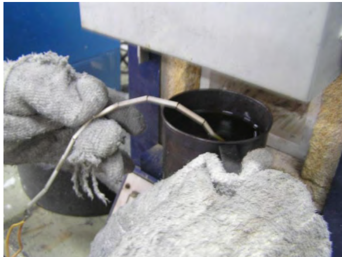
Figura 3. 6: Sales de tratamiento térmico y termopar.
