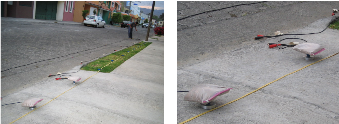
Figura 3.3- Acoplamiento de geófonos sobre el pavimento durante la adquisición de datos en la Ciudad de Morelia (Tomada de Arciniega, 2008).
