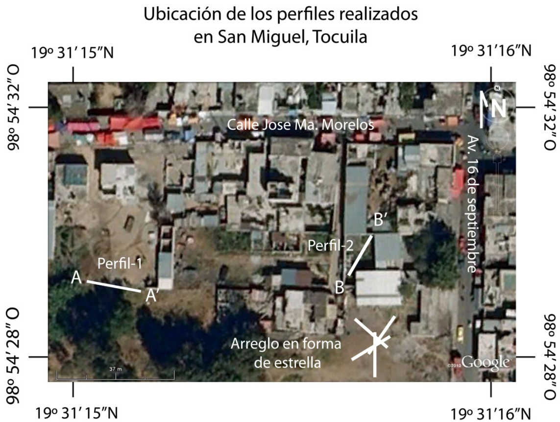
Figura 4.5 - Área de estudio y ubicación de los perfiles de refracción sísmica dentro del poblado de San Miguel Tocuila.
