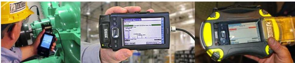
Fig. 38 Analizador de espectro acoplado a una maquina.
