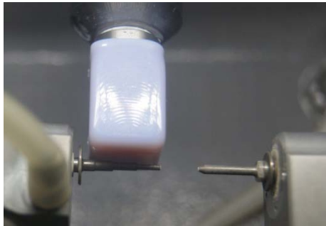
Figura 21 Fresado del bloque IPS e.max CAD
