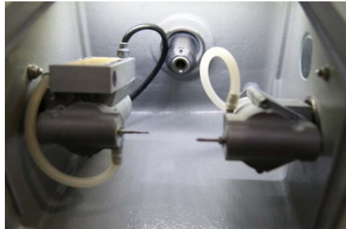
Figura 20 Calibrado automático del bloque cerámico en la unidad de fresado
