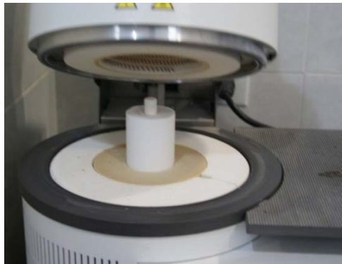
Figura 31 Vista del horno una vez terminado el proceso de inyección.
