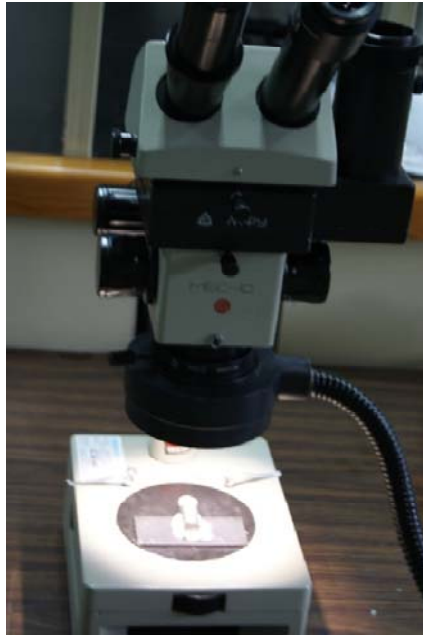
Figura 35 Núcleo cerámico en el dado maestro montado en una platina para su observación al microscopio.
