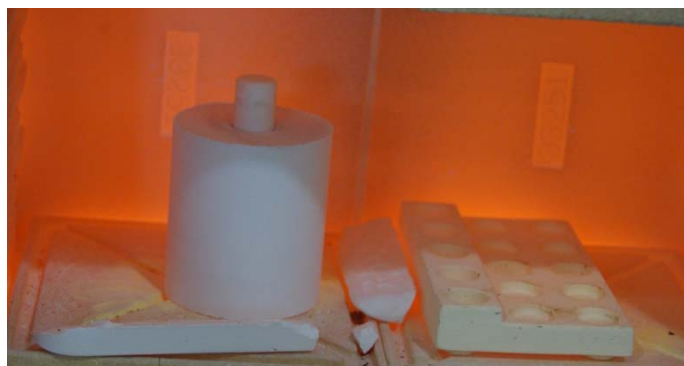
Figura 30 Vista del cilindro dentro del horno de desecero con la pastilla y el pistón in situ .
