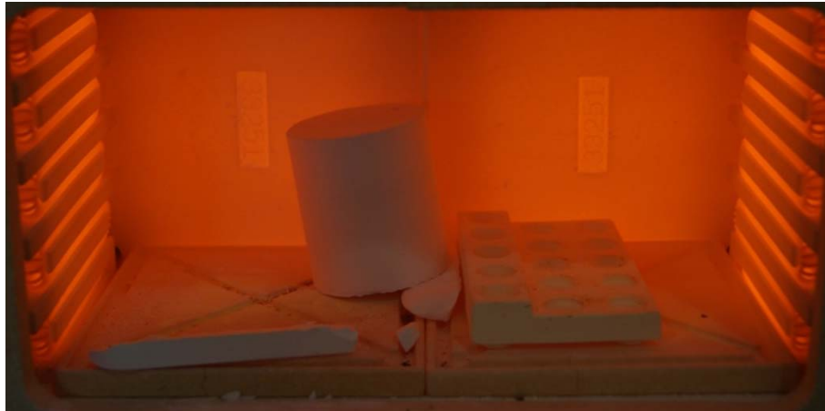
Figura 28 Vista interna del Horno de Desecero a 850°C con el cilindro in situ .
