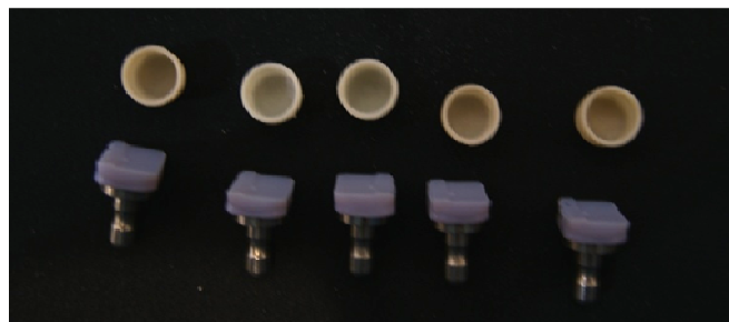
Figura 25 Núcleos IPS e.max CAD (Obsérvese el cambio de color de metasilicato de litio a disilicato de litio)
