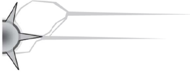
Figura 2.1 – Ilustración diagramática de las trayectorias de flujo restringidas entre las perforaciones y la(s) fractura(s) principal(es), que causan tortuosidad.
