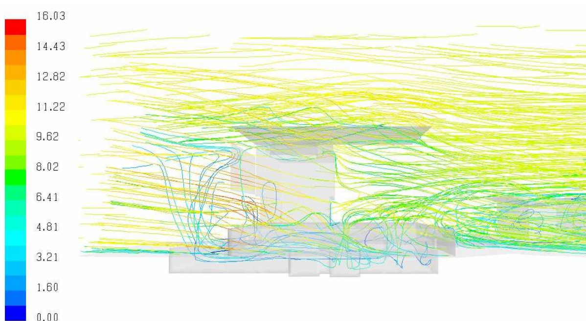
Path lines alrededor de los edificios del CEMER (vestíbulo). A causa de la orientación del edificio con respecto a la dirección de los vientos se lograra una ventilación
