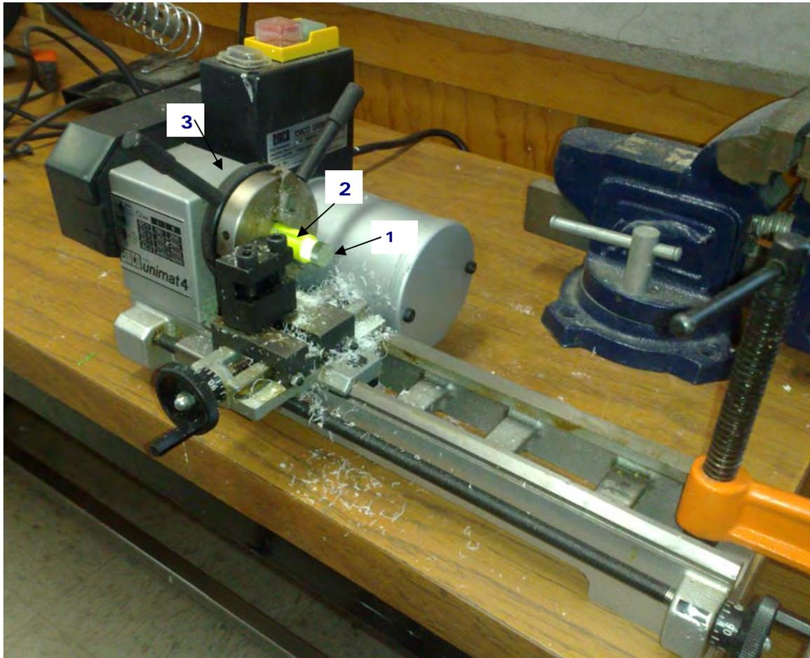
Fig. 6.3. Colocación de pieza de trabajo (barra de PMMA) en el torno; (1) Barra de PMMA, (2) Abrazadera plástica; (3) Torno UNIMAT.
