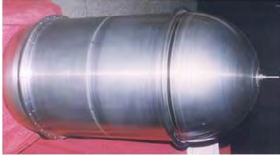
Fig. 2.5. Tanques de tensión superficial [177].
