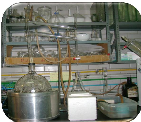
**Figura 14. Aparato utilizado para la extracción de aceites.**
