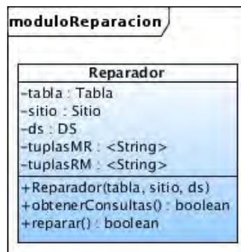
Figura 4.9: Módulo de reparación
