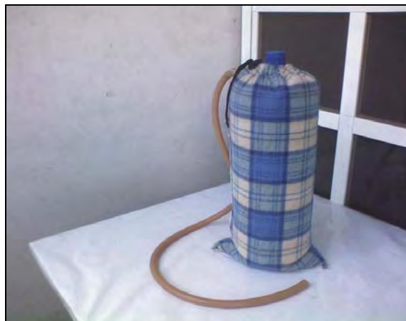
Figura 4. 8 Cubierta aislante del digestor.
