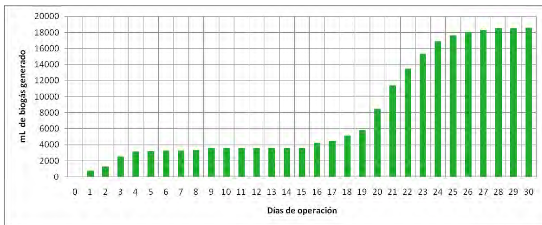
Figura 5. 15 Biogás Acumulado en la etapa a flujo intermitente.
