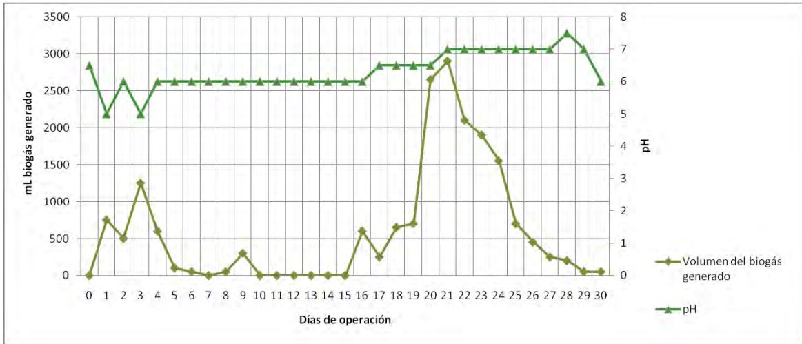
Figura 5. 12 Relación del pH y la producción del biogás en la etapa a flujo intermitente.
