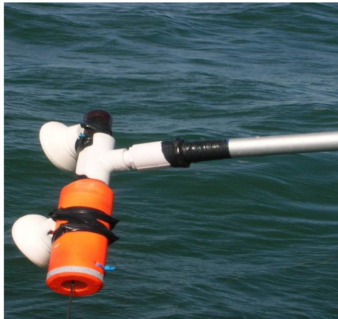
Figura 4. Instrumento con ventosas, unidas al aparato por medio de cinta de aislar y ajustadas con cinturones de plástico y un tubo telescópico de 2-6 m de largo que presenta en su extremo una abrazadera que sostiene la marca.
