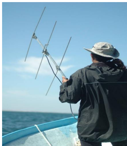
Figura 6. Rastreo de la marca Bio-Probe que fue colocada en la ballena, utilizando una antena Yagi desde el bote.
