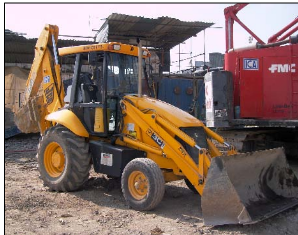
Figura 3.10.- Retroexcavadora con cargador frontal
