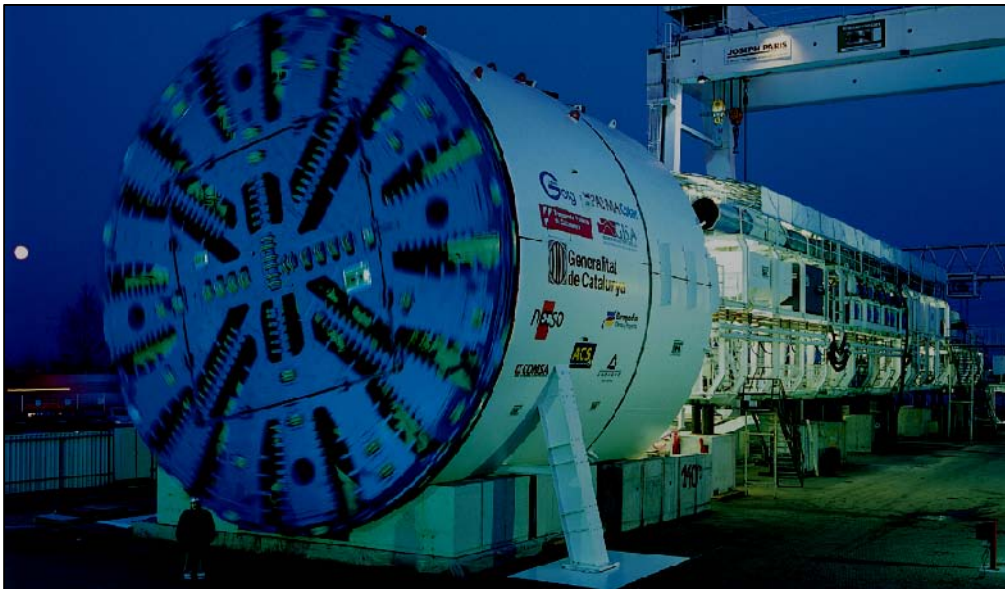
Figura 3.1.- Escudo Utilizado en la excavación del Túneles (EPB Herrnknecht)
