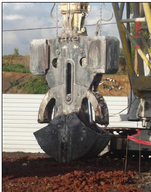
Figura 3.5.- Almeja de 60 cm de ancho y una apertura de 2.40 m, con sistema de cierre y apertura hidráulico
