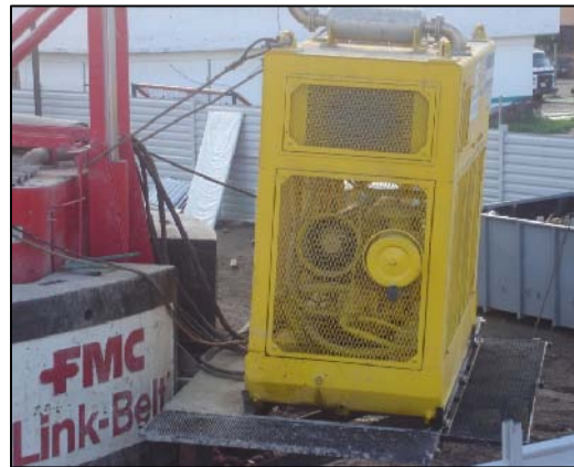
Figura 3.4.- Casagrande motor de equipo guiado
