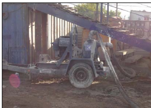
Figura 3.6.- Bombas para lodos, Gorman Rupp, estas deben tener la capacidad para bombear el lodo fraguante
