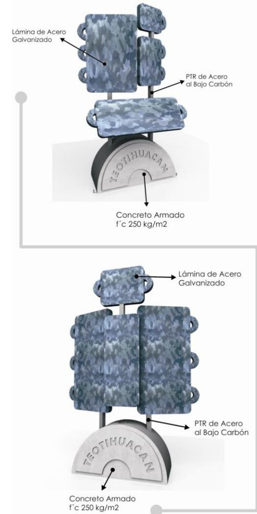
Fig. 3.1 Ejemplo de la aplicación de los materiales para señal de ruta e introductoria.
