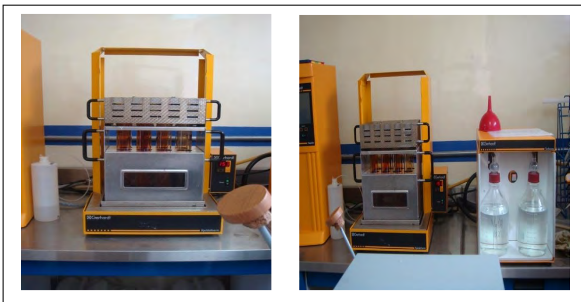
Fig. 6.- Proceso de digestión de las muestras utilizando un digestor marca Gerhardt.
