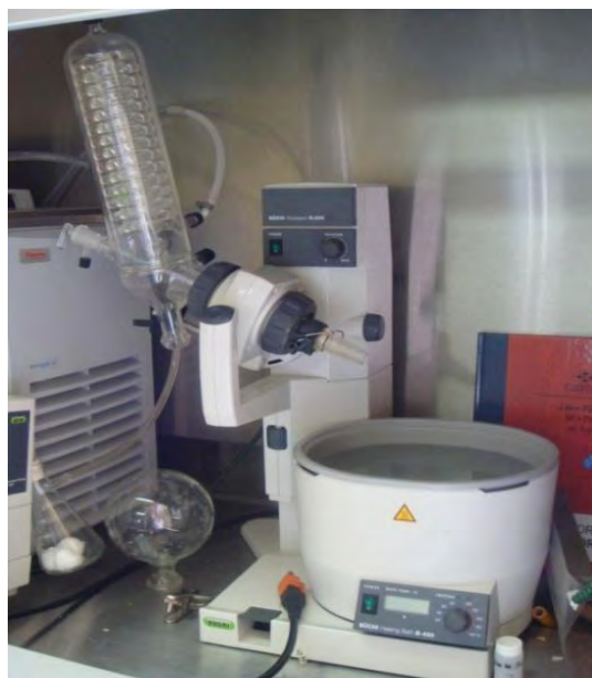
Fig.8.- Concentración de la muestra con el rotavapor marca Büchi R200.
