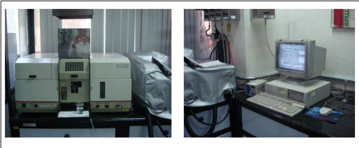
Fig. 7.- Análisis de las muestras en el Espectrofotómetro de Absorción Atómica Varian SpectraAA-100.
