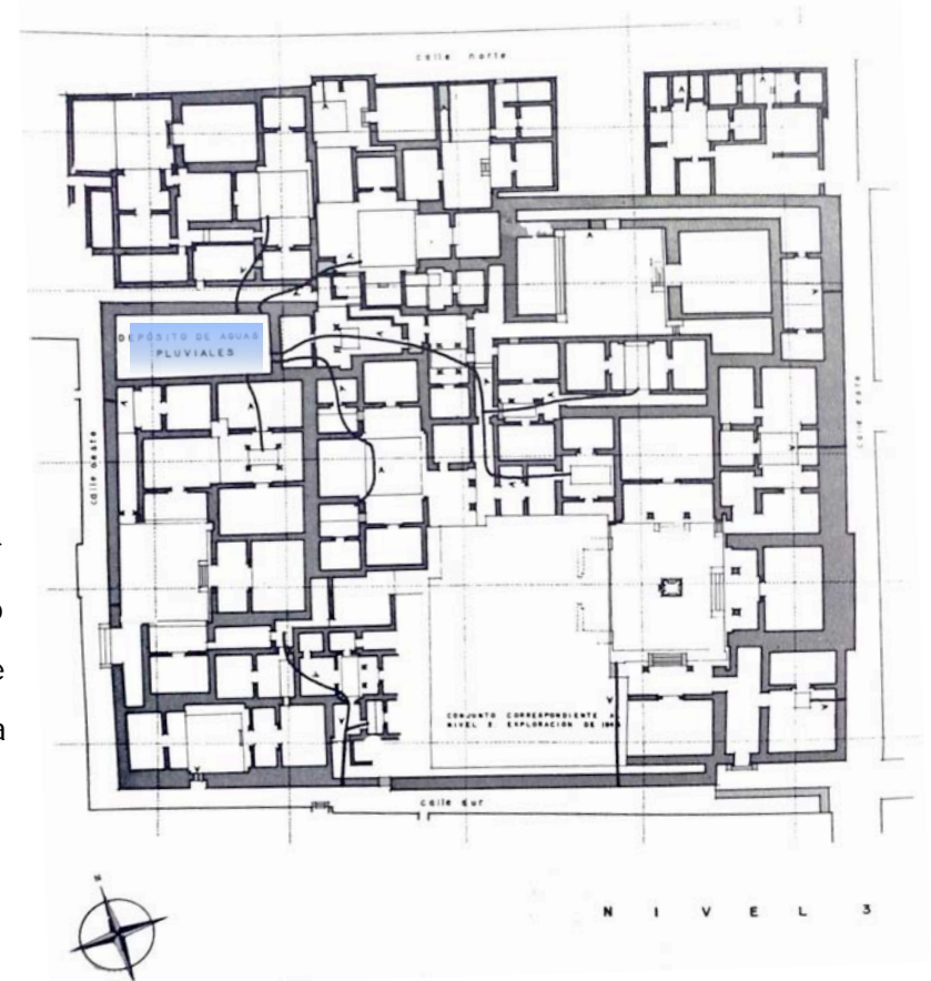
Figura 33. Depósito de agua pluvial y red de desagüe en Tetitla
