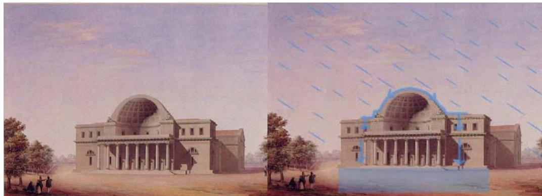
Figura 8. Cisterna de Livorno: La función de las Reservas Públicas Romanas era coleccionar el agua en el techo y almacenarla en la gran cisterna que se encontraba debajo del mismo inmueble.
