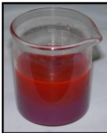
Figura 5.6 En este vaso de precipitados se encuentra material polimérico disuelto en el líquido refrigerante.
