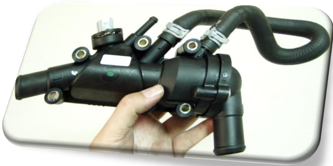
Figura 3.1 Carcasa con elementos del subsistema de enfriamiento.
