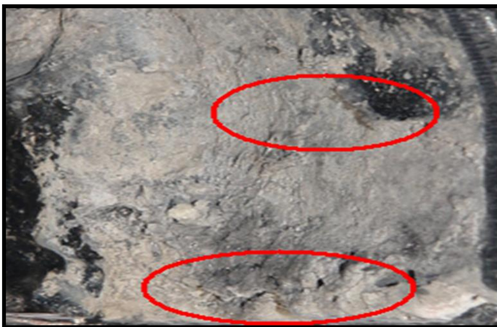
Figura 3.17 Cambio de tonalidad en capa interior de la cavidad de la carcasa.
