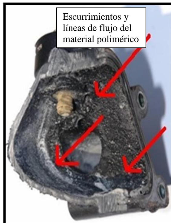
Figura 3.19 Se observan escurrimientos y residuos del polímero.
