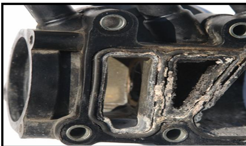
Figura 3.15 Deformación severa producto de la presencia de altas temperaturas, con lo cual se tiene la pérdida de la geometría original.
