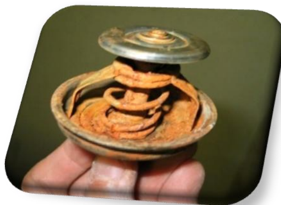
Figura 3.9 Efectos de la corrosión al adherirse partículas en la válvula termostática, lo cual propicia una inadecuada apertura.
