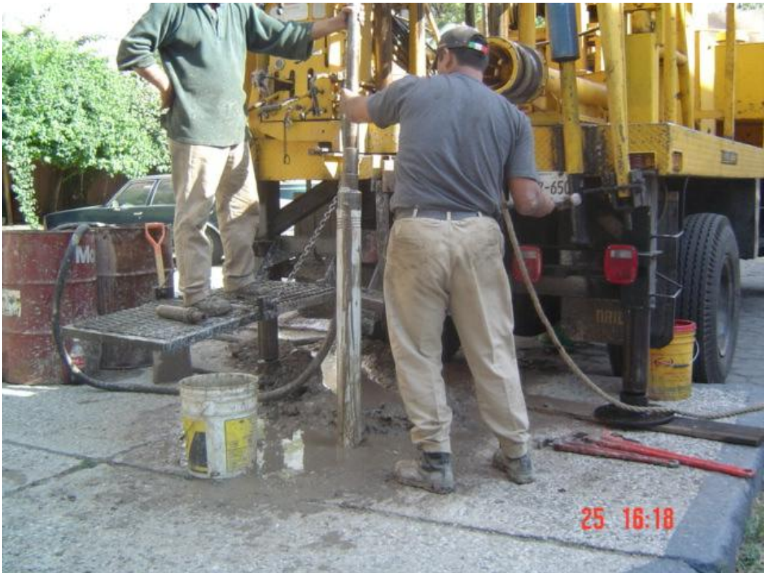
Hincado de tubo shelby para extracción de muestras inalteradas
