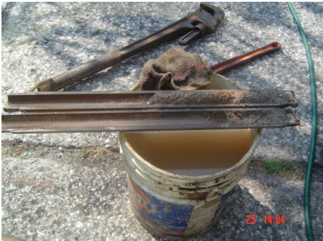
Muestra alterada de material del subsuelo, obtenida mediante el tubo de penetración estándar
