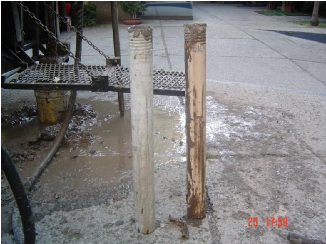
Tubos shelby con muestras inalteradas
