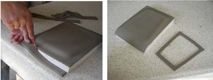
Sobre el molde se coloca una placa de pasta ya con el espesor de 4 mm. Presionando con una esponja se logra que la placa copie la forma del molde.
