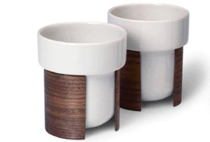
Existen otras opciones en caso de que la taza no cuente con asa. La pieza puede contar con una doble pared, creando una cámara de aire que funciona como aislante térmico. Otro modo es estriar la taza reduciendo el área de contacto que tiene la mano y buscando que el calor se disperse a través de la estría. Por último, puede colocarse un recubrimiento de otro material que conduzca menos el calor, como un plástico o una lámina de madera.
