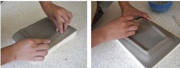
Una vez que la placa copia la forma del molde se corta el excedente de la placa. Por otro lado, de otra placa de 4 mm se corta un trapecio con el tamaño del espejuelo requerido.
