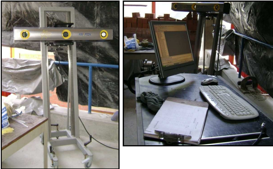
Figura 2.19. Descripción de dispositivos de cámara Krypton 600
