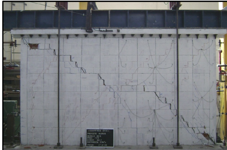
Figura 3.7. Estado final del espécimen ME5
