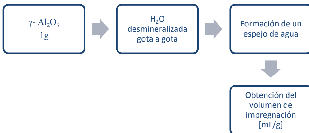
Figura 4.3. Diagrama de proceso para el método de impregnación.
